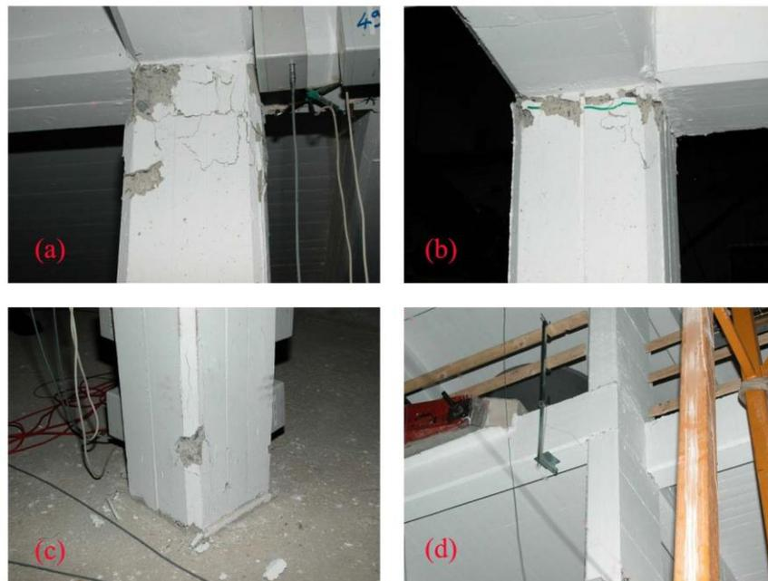
Figure 4-23: Dommages après l'excitation 0.20g pour la structure de référence : (a) Noeud d'ossature en tête du poteau C3, (b) Noeud d'ossature en tête du poteau C1, (c) Point en base du poteau C3, (d) Point de connections du poteau C6
