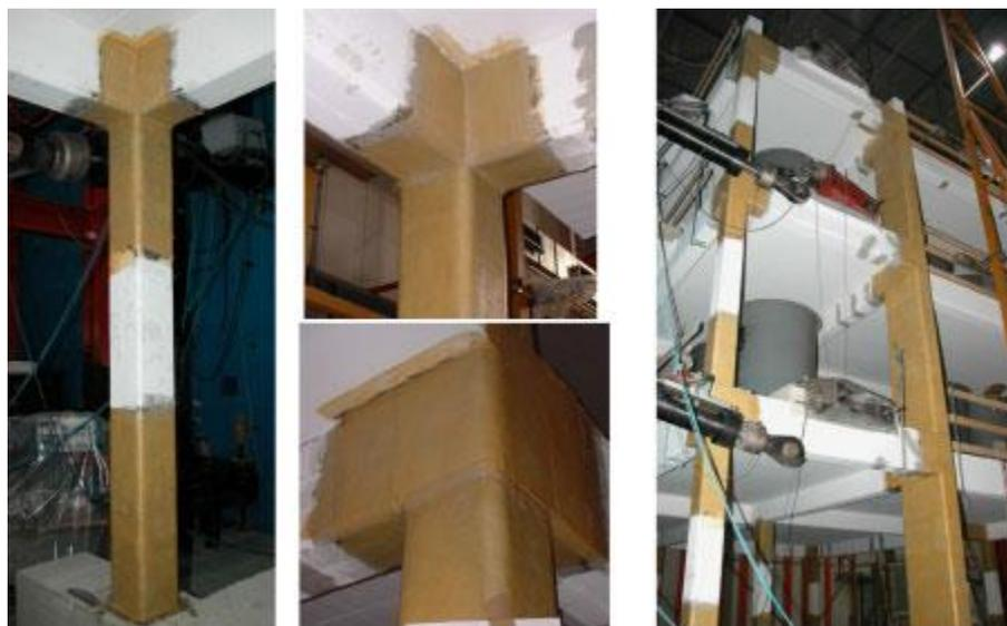
Figure 1-39: Bâtiment asymétrique du projet SPEAR (Di Ludovico et al. (2008))
