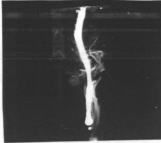
photo 2.3. perturbation de grande longueur d'onde d'un jet d'acier
