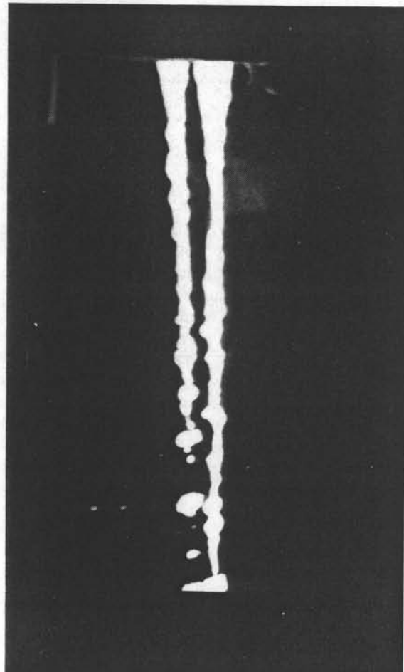
photo 4.8 essais sur acier a) 4 jets d'acier de 8 mm de diamètre (le 2ième jet en partant de la gauche présente une instabilité) b) et c) coalescence de 2*2 jets de diamètre 8 mm (puissance 80 kW, fréquence 107 kHz)
