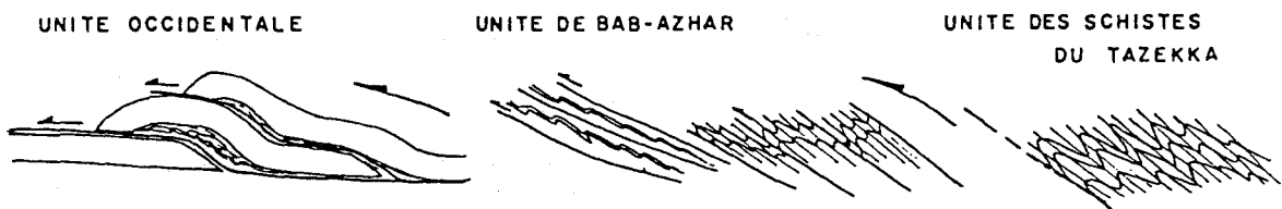
Fig. 120 - Les 3 domaines structuraux du massif du Tazekka pendant les mouvements éovarisques.
