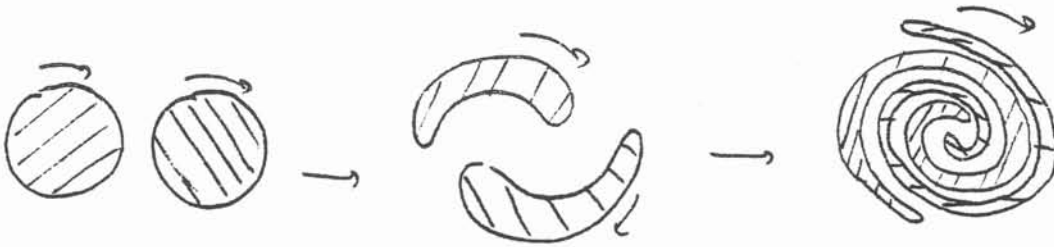
Fig. 4 : Appariement de deux tourbillons. L' chelle du mouvement double alors que les lignes d'isovorticit  sont  tir es, ce qui contribue   la cascade d'entrophie.
