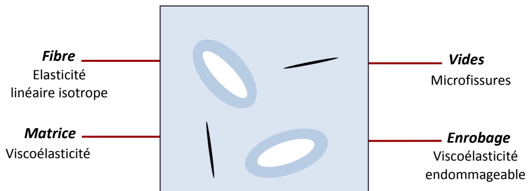
Figure III.3 – Schéma d'un VER du PA66-GF30, avec les différentes phases et leur loi de comportement.
