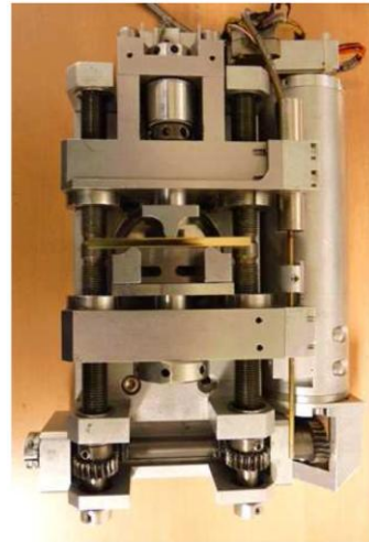
Figure I.38 – Présentation de la machine de flexion in-situ 3 points utilisée avec le MEB [8].
