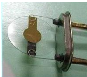
Figure 2.18: Une Microbalance à Quartz utilisée dans le cadre de cette étude.
