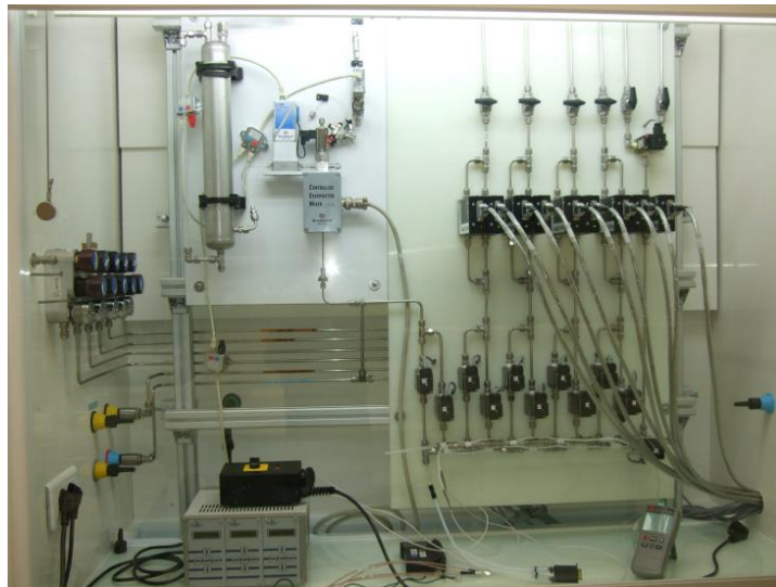
Figure 2.12 : (a) Schéma du banc gaz permettant de générer des concentrations connues d'analyte, ici du toluène (b) image du banc.
