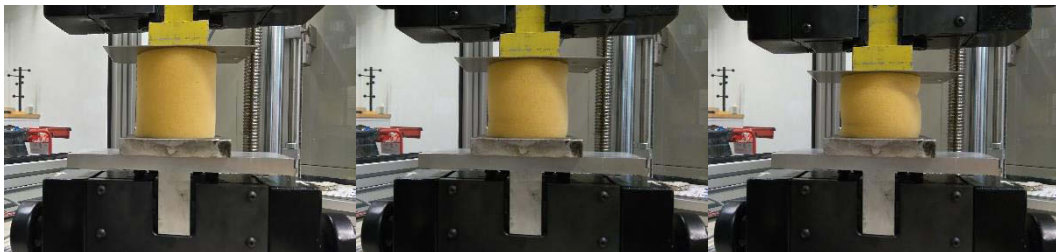
Figure 4-8 Essai de compression d'un cylindre en mousse
