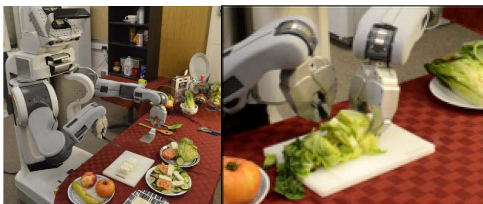
Figure 1-25 Utilisation des capteurs haptiques d'un robot personnel afin d'acquérir les propriétés physiques des objets alimentaires pour la définition des stratégies de manipulation [Gemici14]
