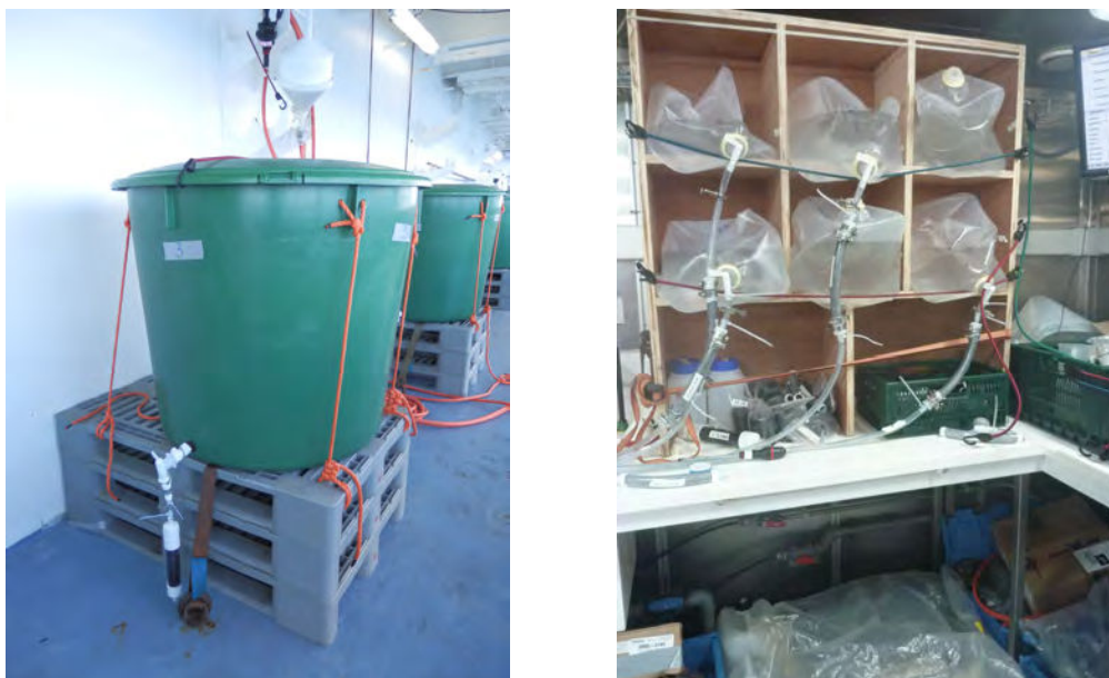
FIGURE 3.3 – A gauche : pré-concentration d'un échantillon d'eau de mer de grand volume. La cartouche de PVC contenant la fibre Mn est connectée directement en sortie d'une cuve de stockage de 450 L. A droite : pré-concentration du radium des échantillons de petit volume ( \sim 10 L) prélevés dans l'Océan Atlantique Nord pendant la campagne GEOVIDE (Annexe A), en vue de la construction d'un profil haute résolution de ^{226}\text{Ra} .
