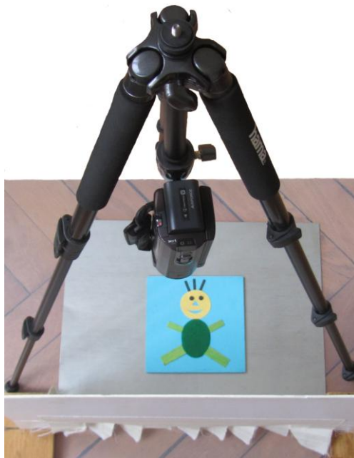
Figure 30. Dispositif expérimental : caméra sur trépied filmant l'image aimantée sur un support métallique.
