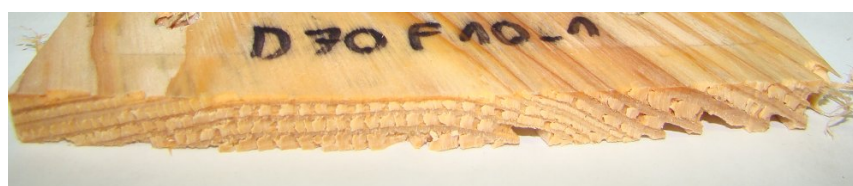
FIGURE 3.27 – Surface coupée d'une éprouvette de douglas ( H = 40\% , GD = 70^\circ , h = 10 mm).
