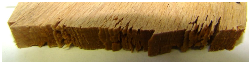
FIGURE 3.25 – Surface coupée d'une éprouvette de hêtre ( H = 60\% , GD = 110^\circ , h = 10 mm).
