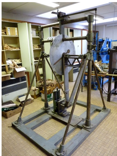
FIGURE 3.8 – Pendule de Chardin du LaBoMaP (Longueur du bras : 1,2 m. Masse du bras : 36 kg. V_c \simeq 420 m.min -1 ).
