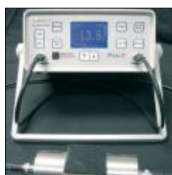
Figure 2-8 : Générateur d'impulsion Pundit 7 et deux transducteurs piézoélectriques
