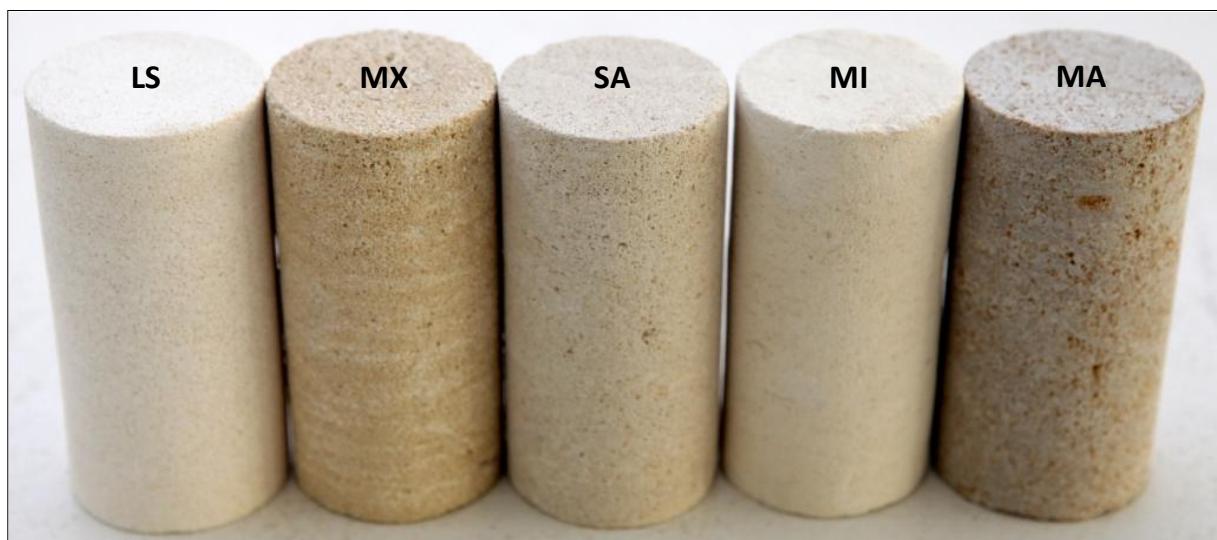
Figure 3-1 : Echantillons de pierres calcaires
