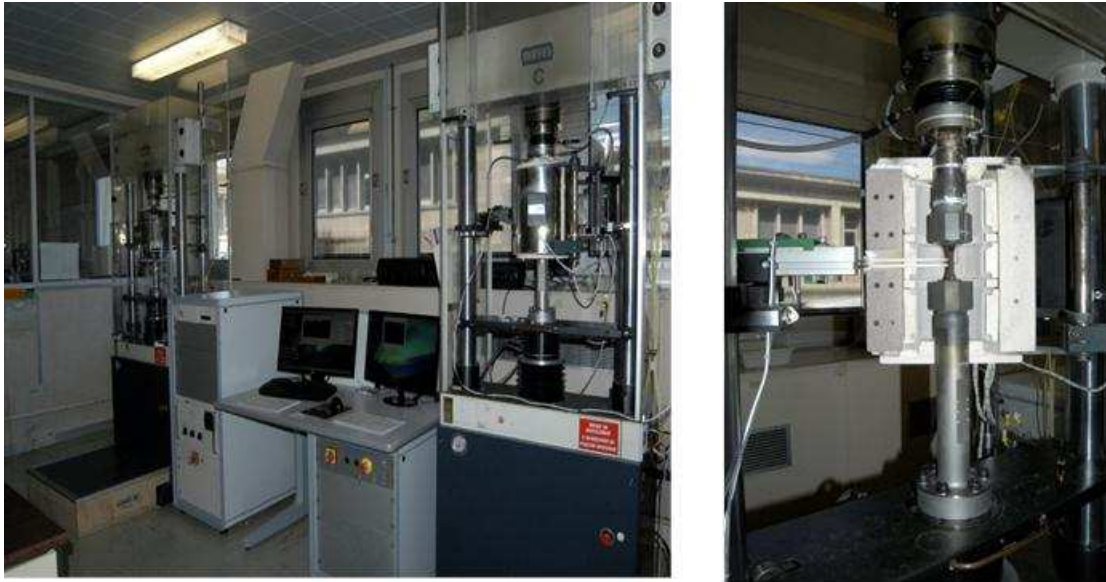
FIG. I-2: la machine MAYES ESM100 utilisée pour les essais
