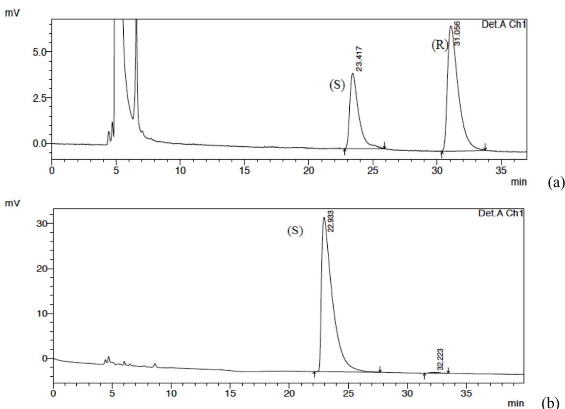
**Figure 4 : Chromatogramme HPLC sur colonne chirale de l'oxyde de phosphine secondaire **193a**. Conditions : Chiralpack IB,  $0.7 \text{ mL}\cdot\text{min}^{-1}$ , hexane / 2-propanol 80 : 20. (a) racémique ; (b) préparé à partir d'acide phosphineux borane chiral**
