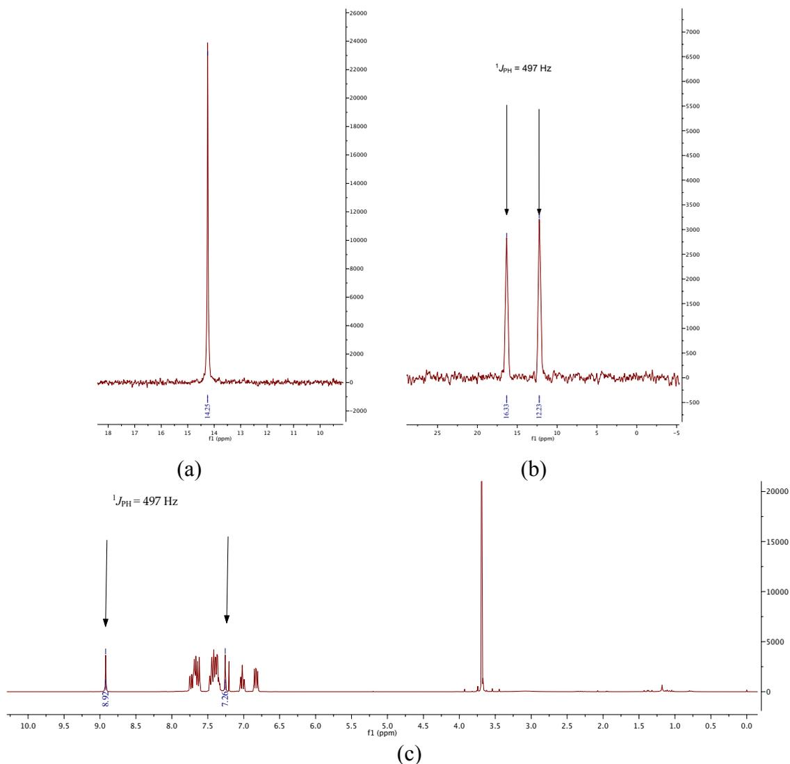
**Figure 5 : Spectres RMN  $^{31}\text{P}$  et  $^1\text{H}$  de l'oxyde de phosphine **193a** : (a) RMN  $^{31}\text{P}$  découplé du proton ; (b) RMN  $^{31}\text{P}$  couplé au proton ; (c) RMN  $^1\text{H}$**
