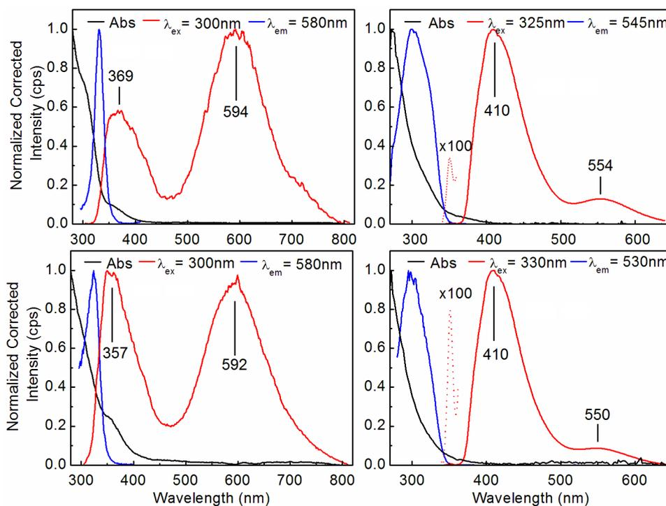
**Figure 18:** Spectre d'absorption (noir), d'excitation (bleu) et d'émission (rouge) du cluster (*R*)-260b (en haut), (*S*)-260b (en bas), dans le méthylcyclohexane, à 298°K (à gauche) et à 77°K (à droite). L'incertitude pour le maximum des bandes est de  $\pm 5$  nm.
