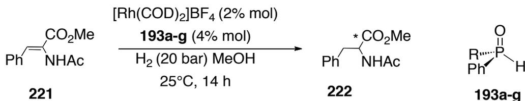
Le précurseur catalytique est préparé *in situ* en mélangeant le complexe cationique  $[\text{Rh}(\text{COD})_2]\text{BF}_4$  avec l'oxyde de phosphine. Les réactions d'hydrogénation sont réalisées sous 20 bar d'hydrogène pendant une nuit dans le méthanol. Les résultats sont présentés dans le tableau 7 ci-dessous.
