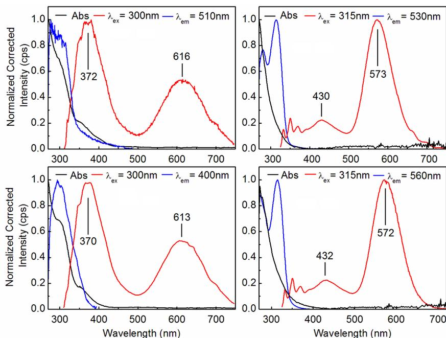
**Figure 17 :** Spectre d'absorption (noir), d'excitation (bleu) et d'émission (rouge) du cluster (*R*)-260a (en haut), (*S*)-260a (en bas), dans le méthylcyclohexane, à 298°K (à gauche) et à 77°K (à droite). L'incertitude pour le maximum des bandes est de  $\pm 5$  nm.
