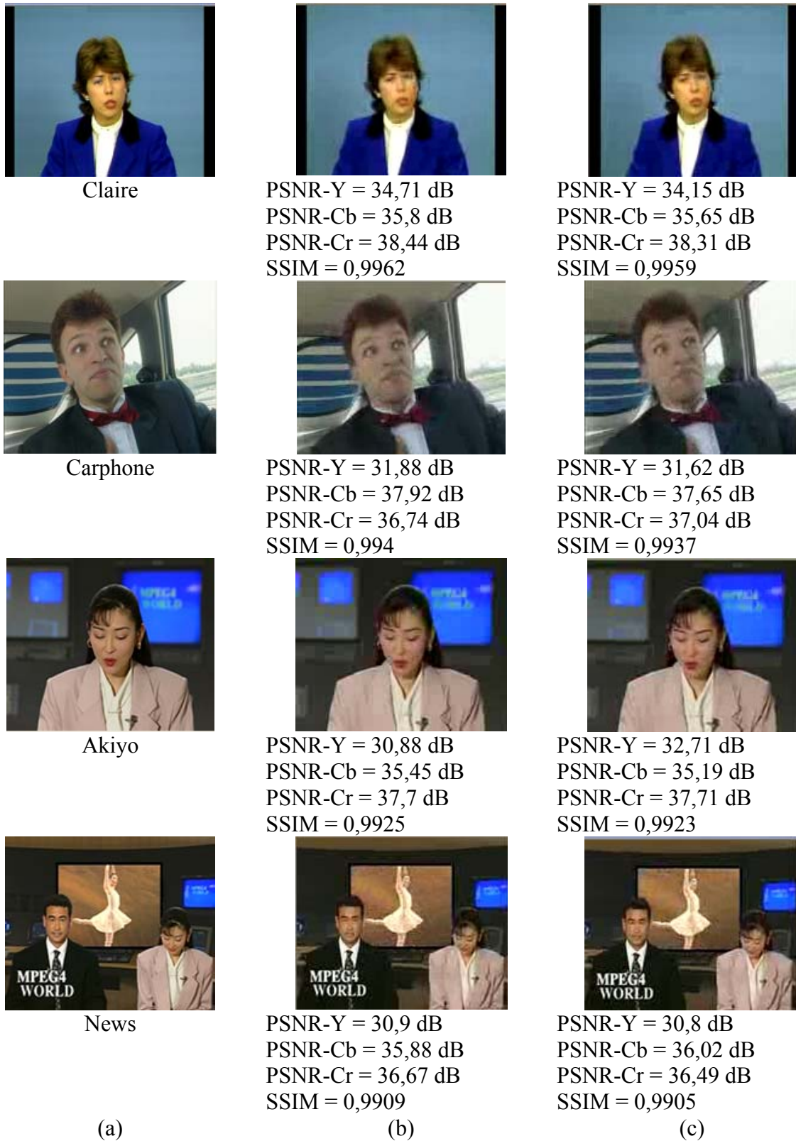
Figure 117. (a) Originale, (b) reconstruite par SW et (c) reconstruite par HW/SW de la 40 ème image des séquences vidéo de test pour QP=13
