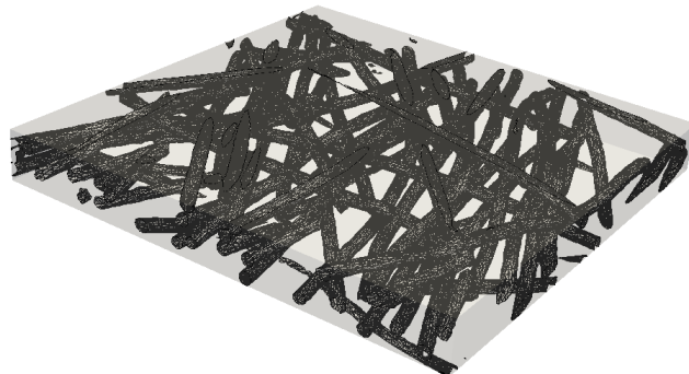
(d) Surface mesh of the iso-zero surface of u_\epsilon^\tau
