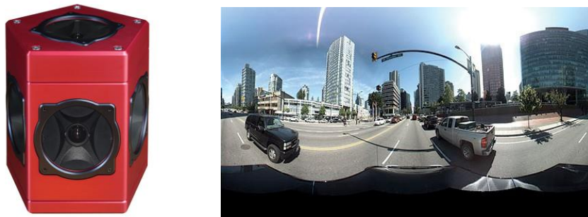
Figure 6 : camera Ladybug (Point Grey) et exemple d'image panoramique obtenue (Source : Point Gray ; http://www.glassworksbarcelona.com/ )
