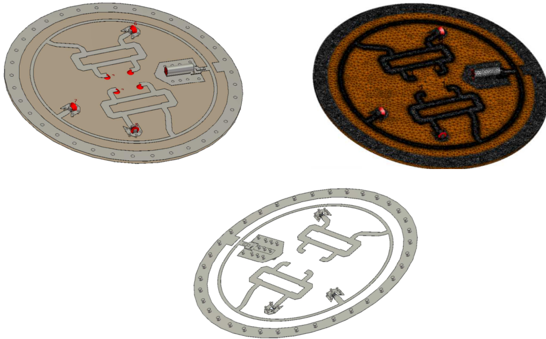
Figure IV-6 : Détails de la modélisation du circuit complet intégrant les charges adaptées et le report de la connectique coaxiale
