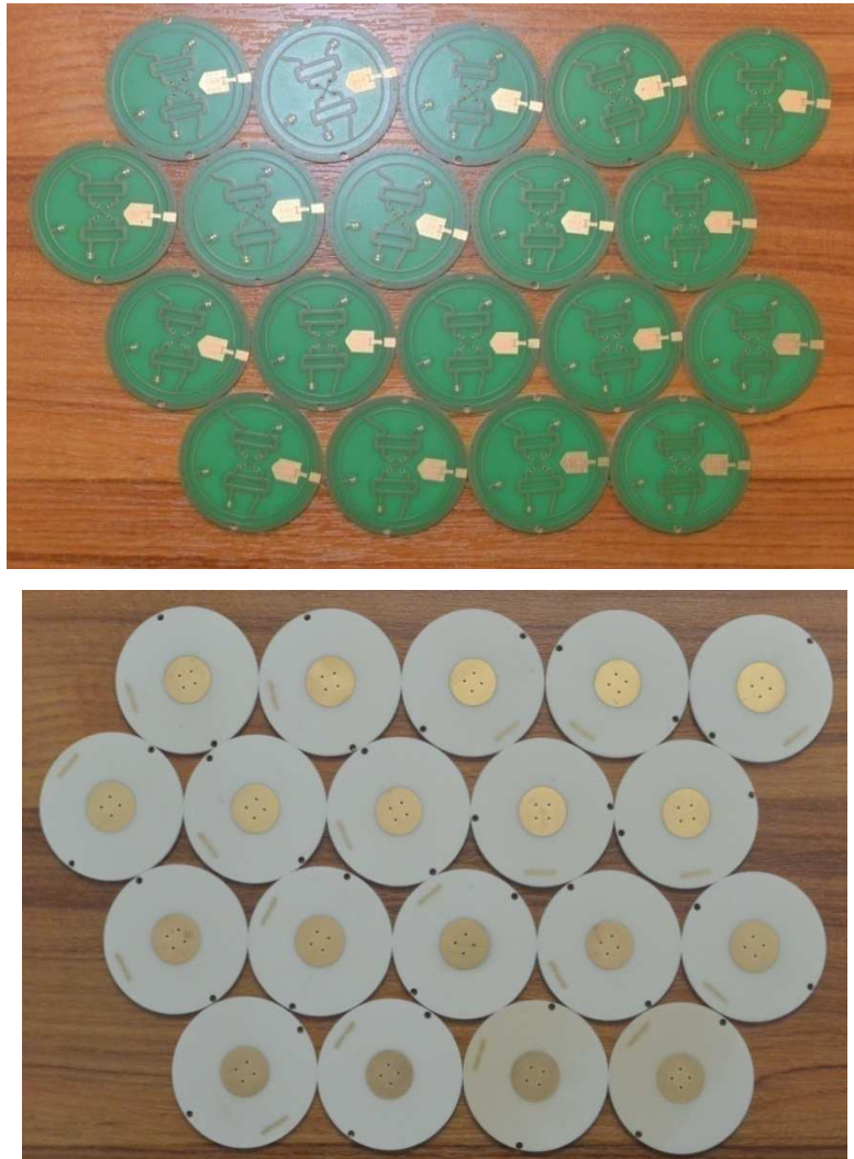
Figure IV-33 : Echantillon des variantes de circuits fabriqués.
