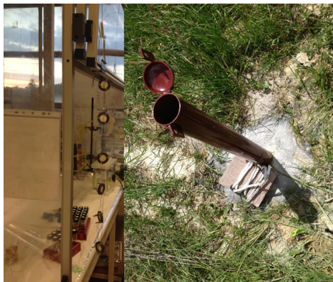
Figure 40. POCIS miniaturisés (à gauche) pour exposition dans le piézomètre (à droite)
