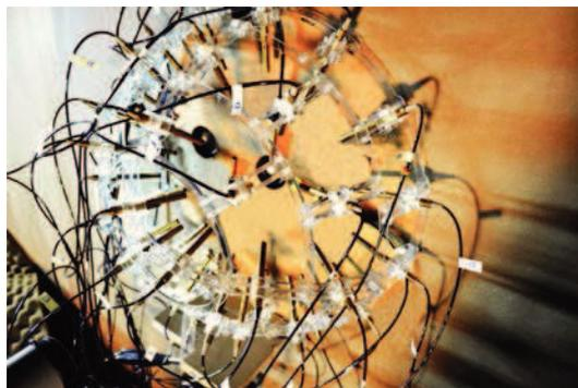
FIGURE 2.29 – Antenne hémisphérique double couche
