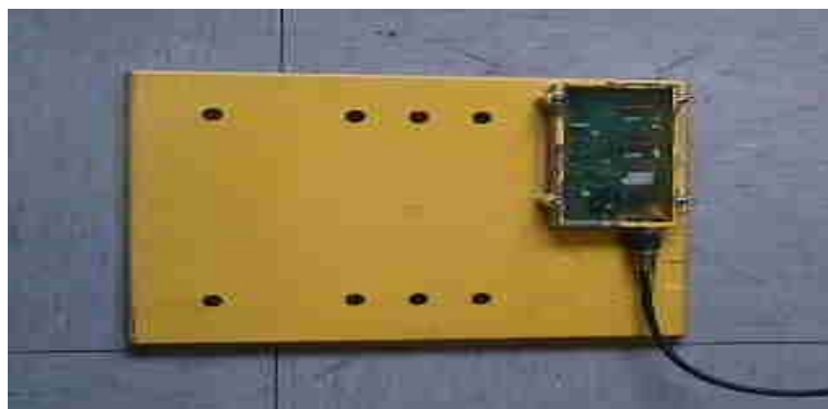
Figure 1.3 : Vue externe d'une balise munie d'un codeur associé
