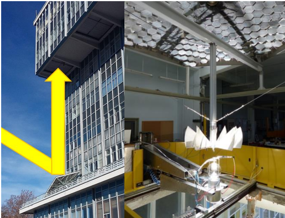
Figure 2.1. Vues extérieure (gauche) et intérieure (droite) du four solaire vertical 6kW avec le dispositif expérimental installé au foyer.
