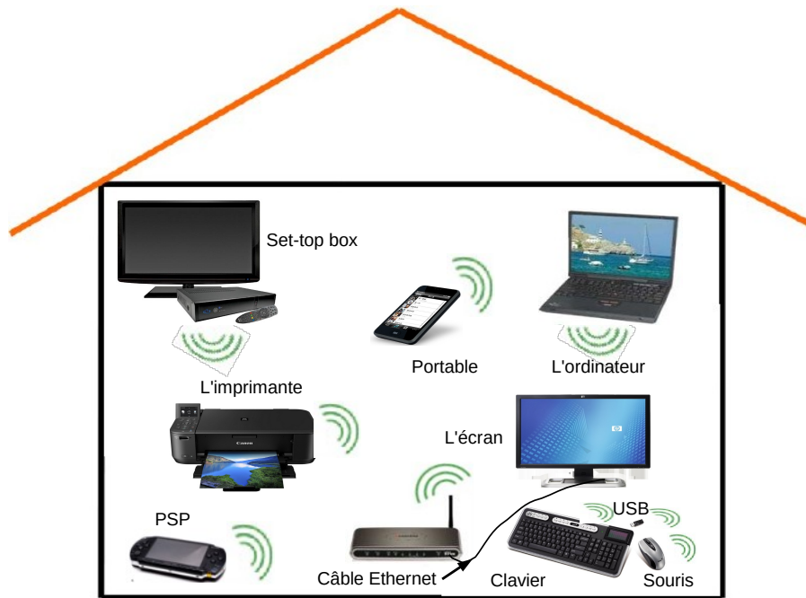
FIGURE 1.1 – Réseau type de communications domestiques
