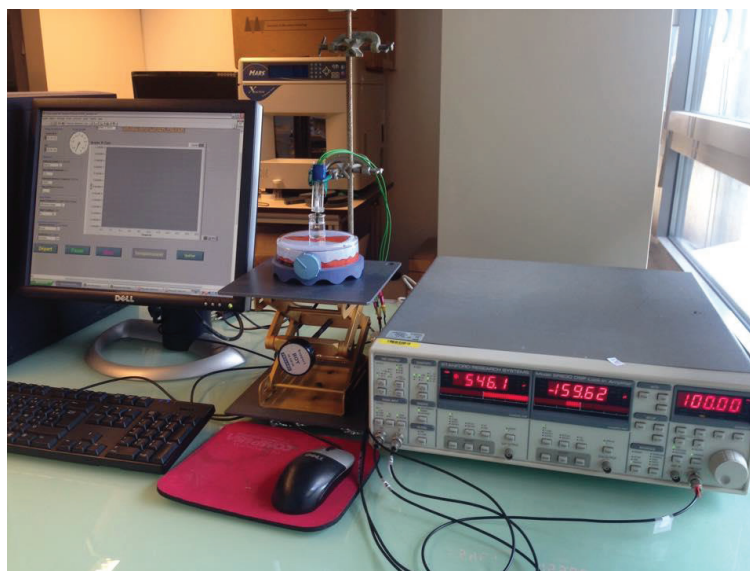
Figure II.7. Dispositif expérimental pour la mesure conductimétrique.
