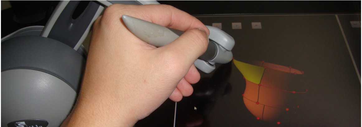
FIGURE 4.10 – Utilisation du bras haptique pour le déplacement d’un nœud sur notre modèle 3D.
