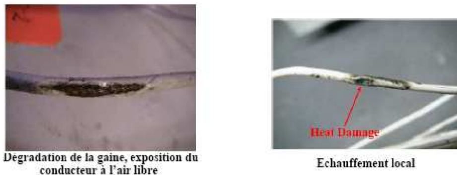
FIGURE 1.3 – Exemples de défauts non francs (source : [57]).
