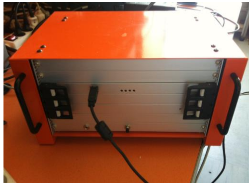
Figure 2.4 : Echographe de recherche ULA-OP utilisé pour l'implémentation des OT.
