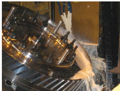
Figure 4 : Fluide de coupe projeté sur une pièce métallique en cours d'usinage. (Source : J.B. Murat©).
