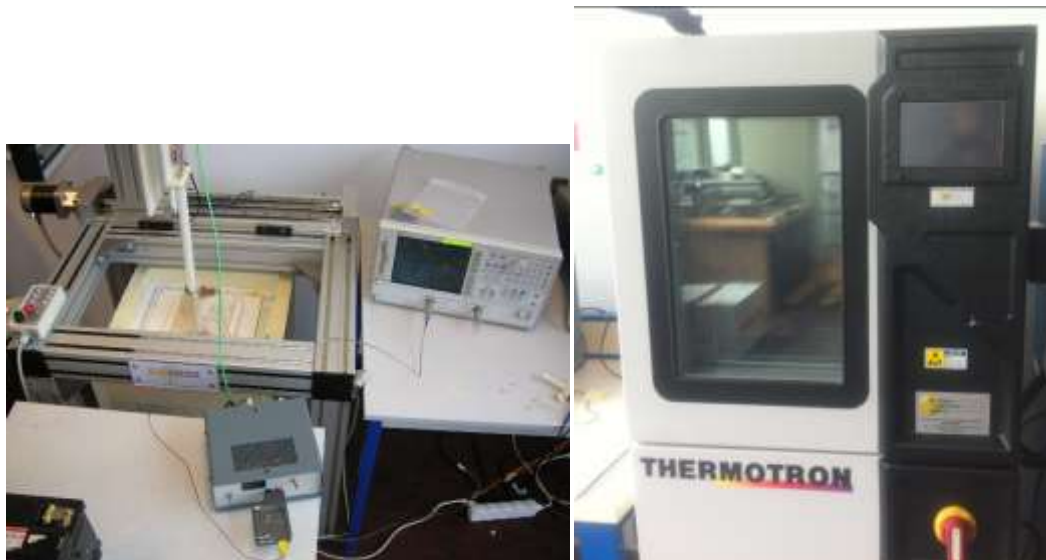
Figure III.24 : Dispositif de mesure thermique en rayonné (à gauche) et conduit (à droite)
