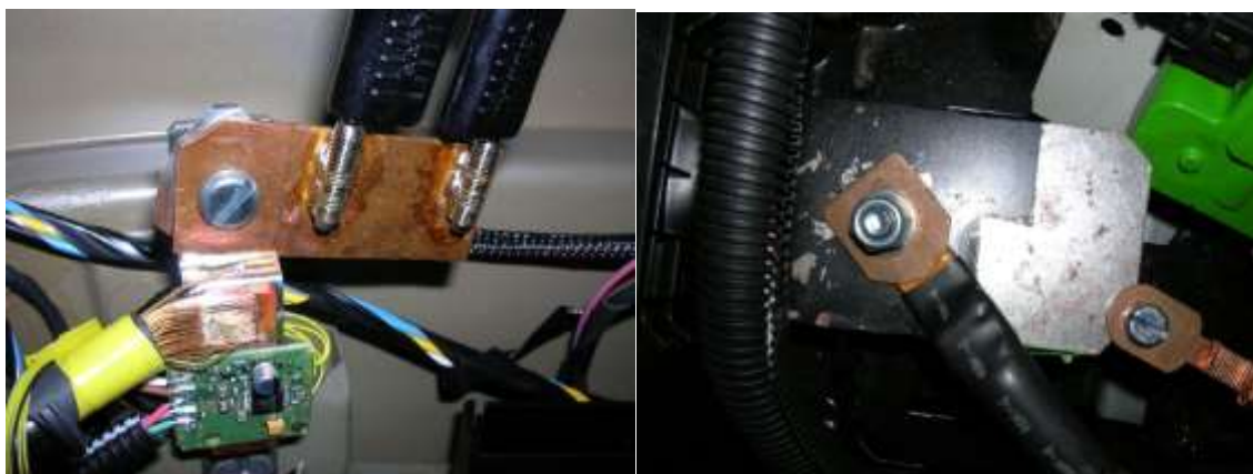
Figure III.5 : Connexion faisceaux vers instruments de mesure
