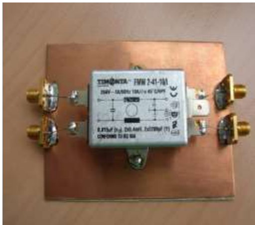
Figure III.16 : structure du filtre modélisée (FMW 2-41-10 - TIMONTA)
