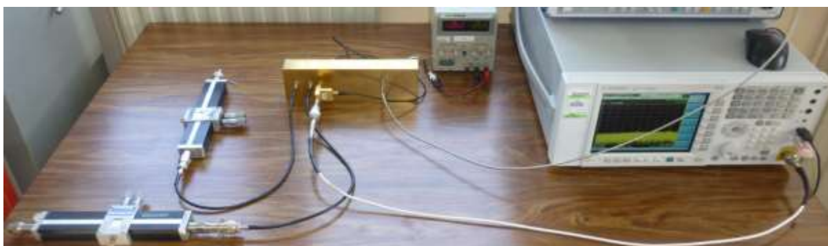
Figure III.14 : Validation des simulations avec tuners d'impédance
