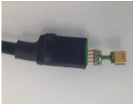
Figure II.8 : Centrale d'acquisition et capteur SHT75 de type Sensirion
