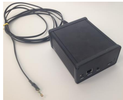
Figure II.8 : Centrale d'acquisition et capteur SHT75 de type Sensirion
