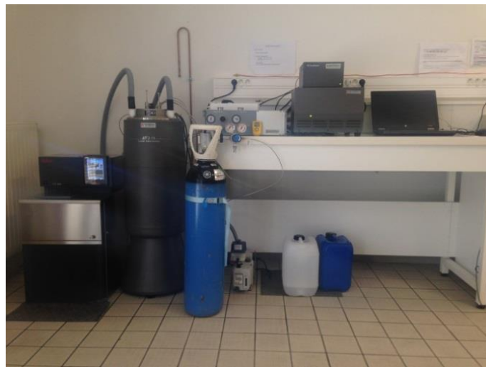
Figure III.25 : Dispositif de mesure de la chaleur spécifique
