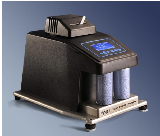
Figure III.15 : Photo du dispositif VSA « Vapor Sorption Analyzer »
