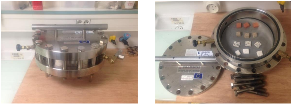
Figure III.18 : Extracteur à membrane (modèle 10120 de Soil-Moisture Equipmnet Corp)
