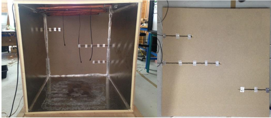
Figure IV.15: Positionnement des capteurs hygrothermiques dans le dispositif expérimental
