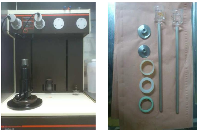
Figure III.2: Porosimètre à mercure Micrometrics-Autopore III 9420
