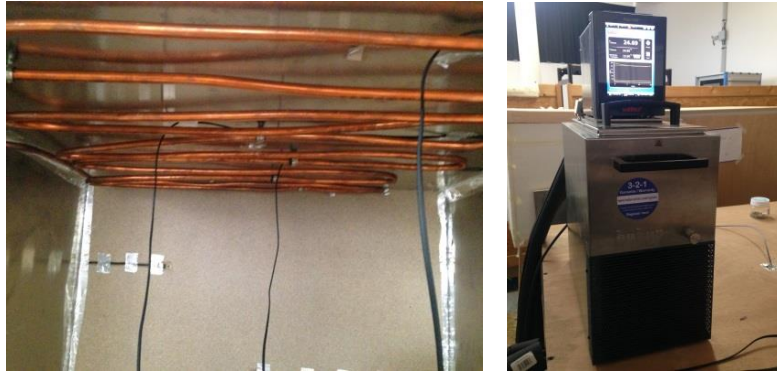
Figure IV.11: Système de régulation thermique : échangeur de chaleur (à gauche) et cryostat « Huber » (à droite)
