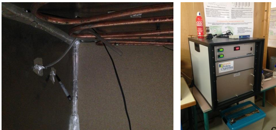
Figure IV.12: Contrôle hygrométrique : Michell Humidity Generator10
