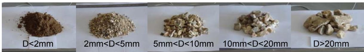
Figure 7.67 : Séparation des cinq fractions granulométriques du sol limoneux de diamètre D.
