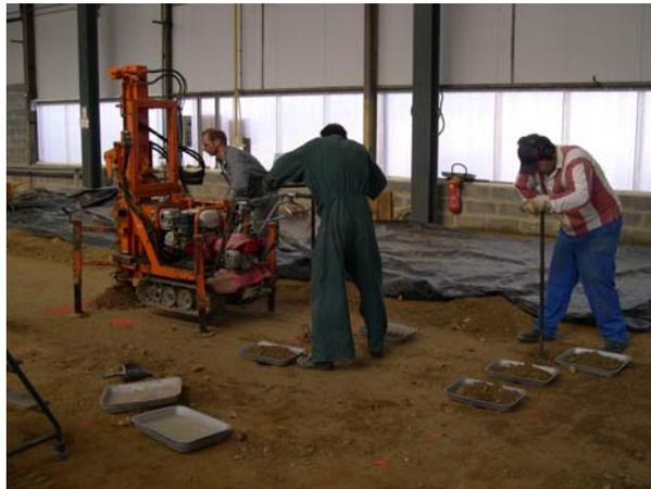
Figure 7.9 : Prélèvement de limon (par foreuse, à gauche, et par tarière à main, à droite) pour les mesures de teneur en eau
