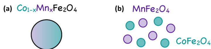
FIGURE 4.1 – Schémas (a) d'une nanoparticule mixte et (b) d'un ferrofluide binaire composés de cobalt et manganèse.
