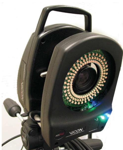
Figure 2.2: Camera Vicon® pour la capture de mouvement.
