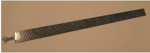
FIGURE 9.15 – Poutre en fibres de carbone comportant quatre transducteurs piézocéramiques
