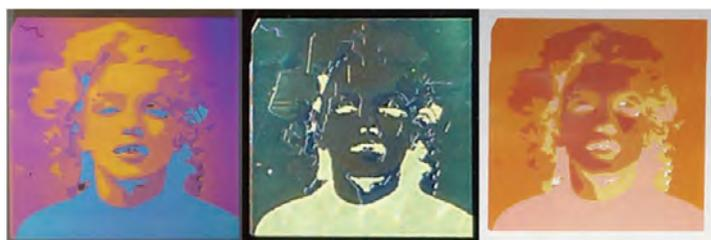
Fig. 24. Image inscrite par laser sur verre enduit d'oxyde de titane ( $2 \times 2$  cm), éclairée par l'avant (à gauche), de côté (au centre) et par l'arrière (à droite).
