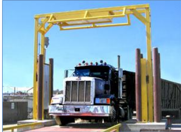
Figure 1-1 : Un portique de détection pour véhicules routiers.
