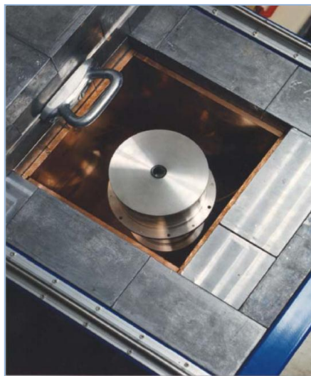
Figure 3-18 : Détecteur cristal NaI(Tl), muni d'un puits au fond duquel l'échantillon à mesurer est placé ( 4\pi sr) (source : LNHB).
