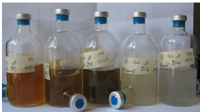
Figure 26 : Réacteurs discontinus avec cultures anaérobies de Shewanella - graduation de la coloration par rapport à la consommation de fer : \text{Fe}^{3+} + \text{e}^- \rightarrow \text{Fe}^{2+}
