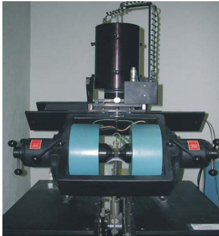
Figure 18 : Exemple de magnétomètre à échantillon vibrant VSM permettant de mesurer l'aimantation en fonction du champ appliqué sur une large gamme de champ ( \pm 1\text{T} ). Source http://auracenter.fr/Art/D%C3%A9tection.html
