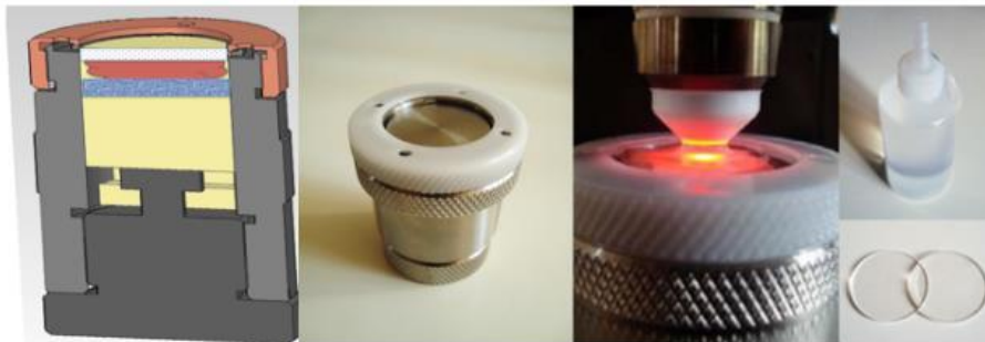
Figure 26 : schéma en coupe (à gauche) et photos (au centre) du porte-échantillon développé. À droite le liquide d'immersion conditionné en bouteille et les lames de recouvrement de l'échantillon.
