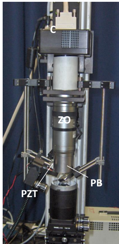
Figure 42 : détails du montage expérimental réalisé. ZO : objectif zoom ; C : caméra ; PB : lame pelliculaire ; PZT : actionneur piézoélectrique.
