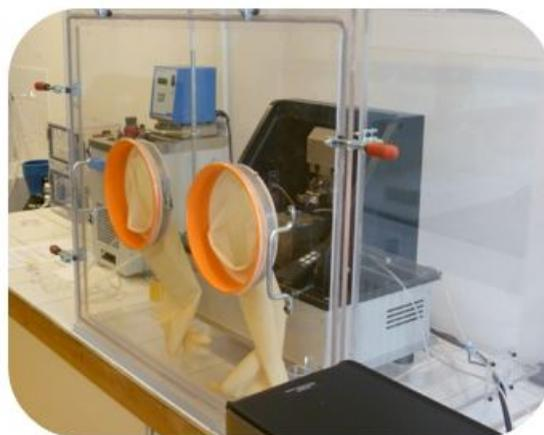
FIGURE 4.20: Nanotribomètre de la société CSM Instruments dans une enceinte environnementale.
