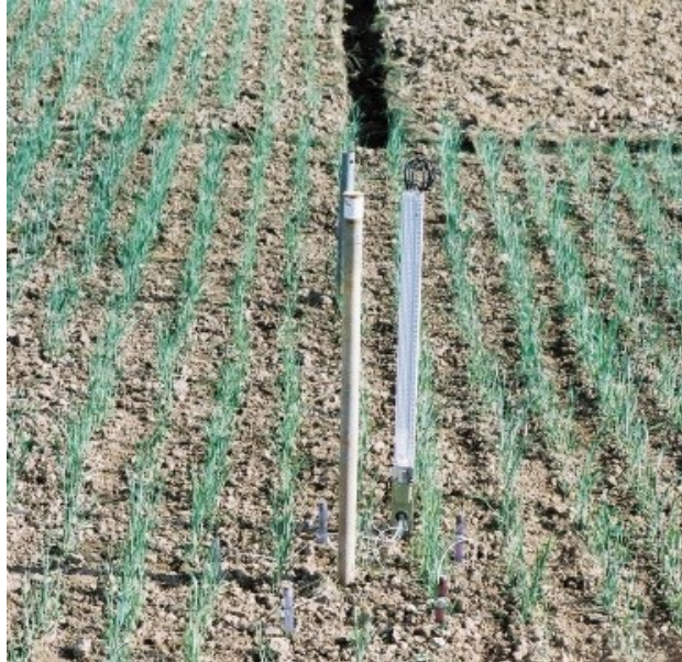
Etude des remontées capillaires en culture de triticale de contre-saison : une seule batterie de tensiomètres (par répétition) permet de suivre les flux d'eau verticaux
