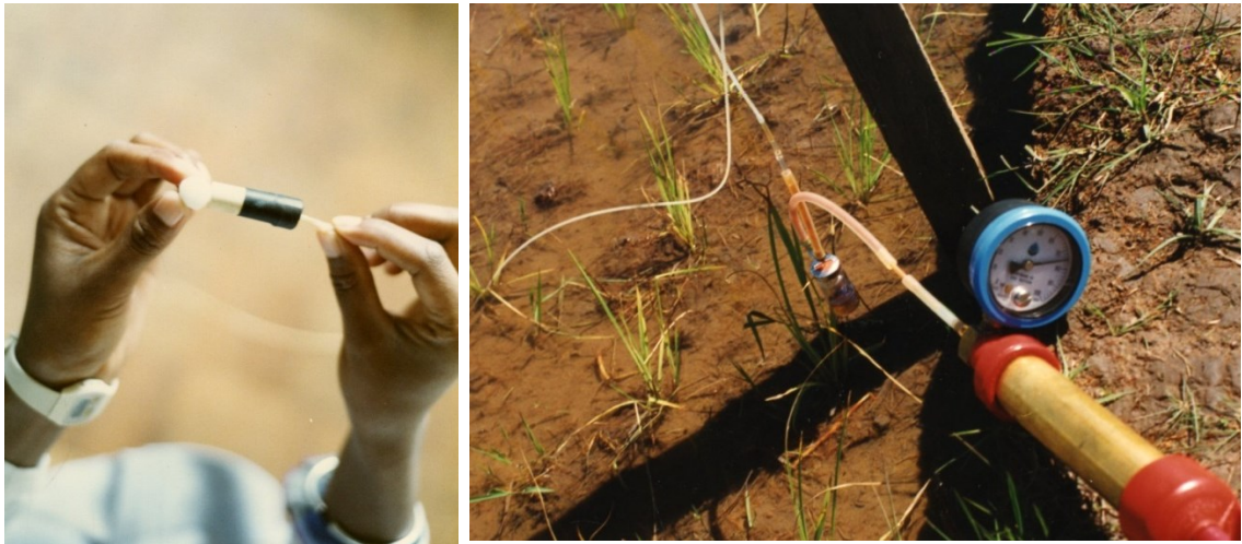
Figure 11. Vue de l'ensemble SGU-préleveur (à gauche) et de la pompe manuelle qui produit le vide qui permet de récupérer la solution du sol dans un flacon à pénicilline. L'ensemble SGU-préleveur est enfoui à 10 cm de profondeur entre 4 touffes de riz au moment du repiquage (photos R. Gaudin)
