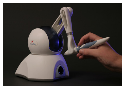
FIG. 1.19 – La Space Pilot ® de 3D Connexion® (à gauche). Le Phantom Omni ®, dispositif haptique de Sensable® (à droite).
