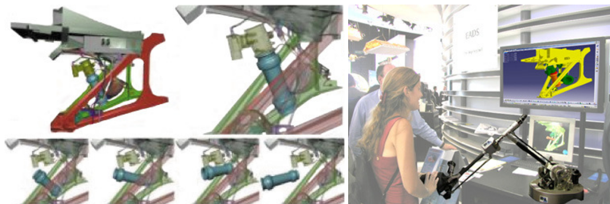
FIG. 1.24 – L’application Samira ® à l’essai. Le cas d’application mis en œuvre ici permet de vérifier que la pièce manipulée (en bleu sur la figure de gauche) par le Virtuouse ® , est bien démontable du bras maître (dispositif auquel est accroché un réacteur - en jaune sur la figure de droite) d’un Airbus ® A380 ® en situation.
