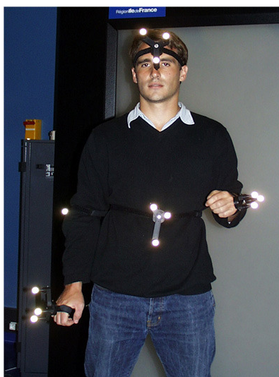
FIG. 4.7 – Marqueurs destinés à observer les mouvements de l’acteur par capture de mouvement optique.
