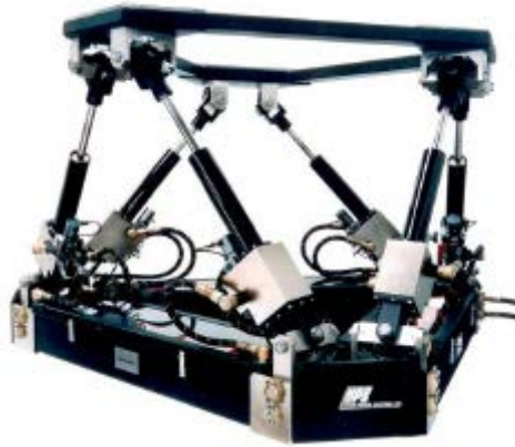
Figure 1.8 : Mécanisme pleinement parallèle de type Hexapode
