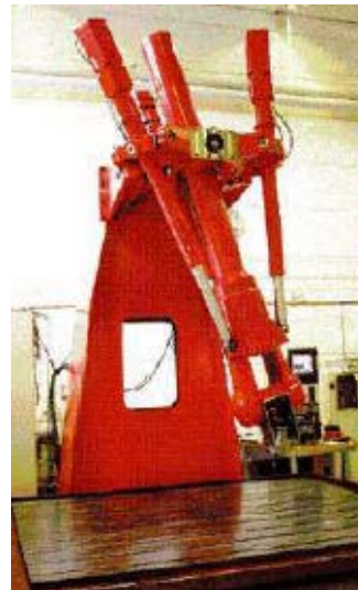
Figure 1.21 : Le Tricept de Neos Robotics
