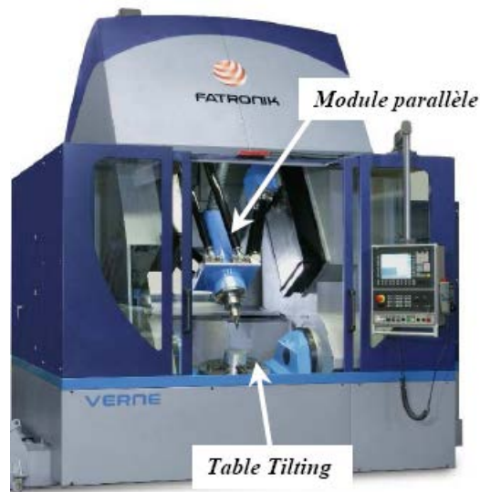
Figure 1.11 : La machine Verne construite par Fatronik pour l'IRCCyN
