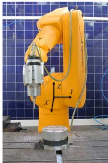
Figure 2-6 : Configuration du robot où l'usinage est instable [Olabi et al. 2014]
