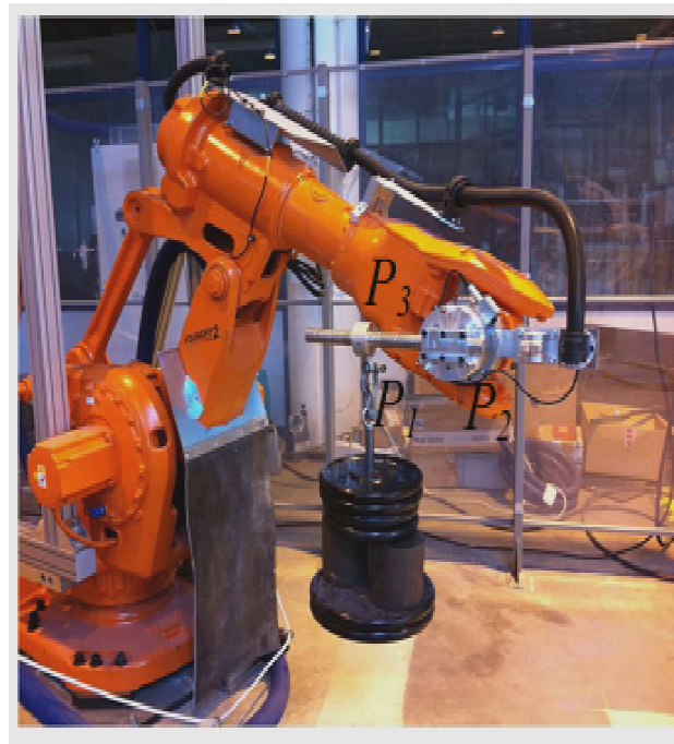
Figure 3-5 : Charge statique en bout d'effecteur pour solliciter des axes [Subrin 2013]
