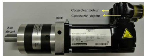
Figure 101 : Servomotoréducteur BSH0551P31A2A
