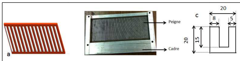
Figure 73 : a) Peigne, b) Peigne avec le cadre, c) Profil de montant
