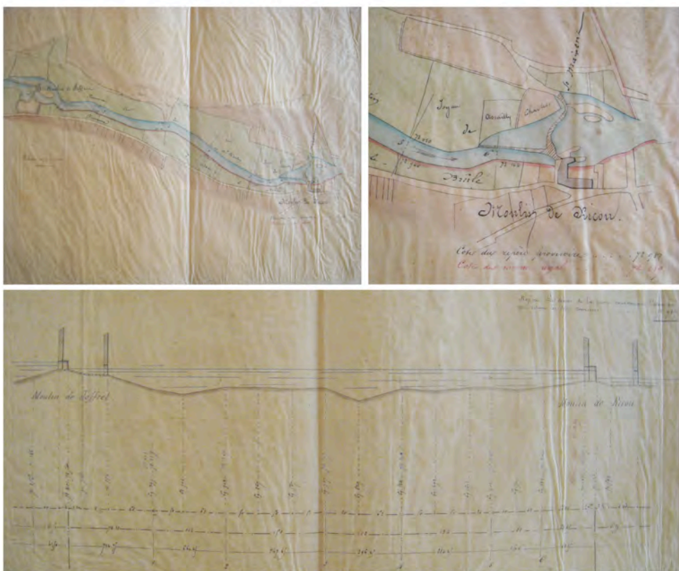
Figure 4. Règlement d'eau de l'usine de Ricou : pièces graphiques (plans et profil en long). AD 79 SC 8807
