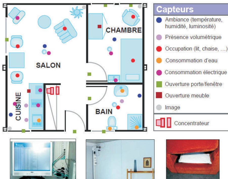
FIGURE 1.7 – Le réseau de capteurs, déployé dans toutes les pièces à des endroits stratégiques, dans le cadre du projet GER'HOME, permet d'analyser précisément l'activité de la personne et de détecter d'éventuelles anomalies.
