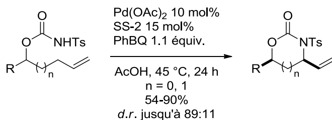
Schéma 117 : Synthèse d'oxazolidinones et d'oxazinanones catalysée au Pd(II) développée par Poli.
