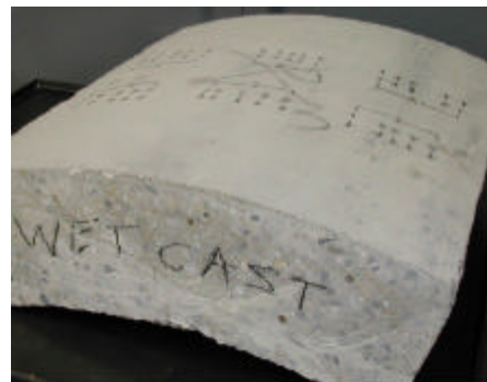
(d) Wet-cast Concrete
