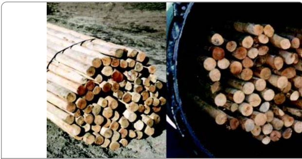
Figura 123. Detalle de los polines previo a la impregnación.
