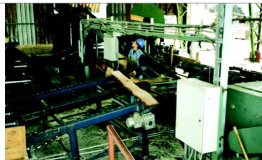
Figura 21. Sierra huincha de brazo radial, marca INDUMET de 5 pulgadas de ancho y 2 mm de espesor.
