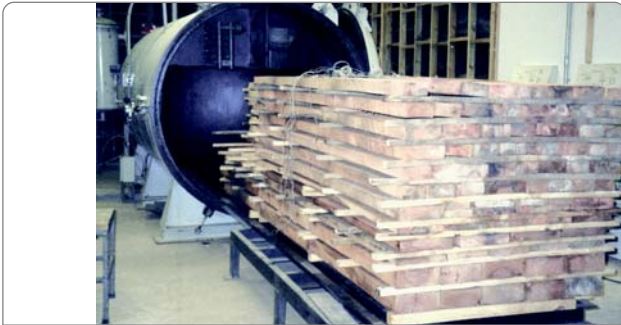
Figura 114. Materia prima para el ensayo de secado y cámara de secado utilizada.
