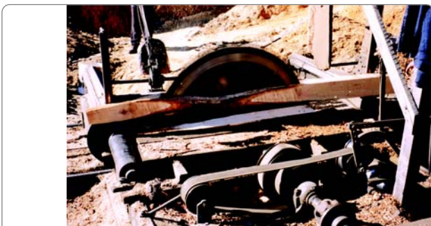
Figura 27. Sierra canteadora de 126 cm de diámetro.
