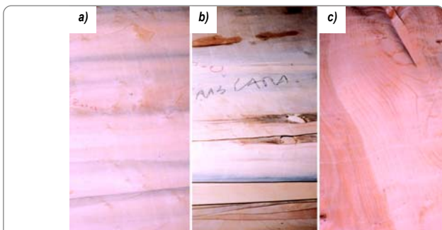
Figura 67. a. Láminas de mejor calidad (cara). b. Láminas de calidad intermedia (trascara). c. Láminas de menor calidad (alma).
