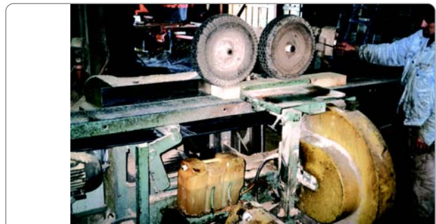
Figura 40. Vista de reaserradora ECASO.
