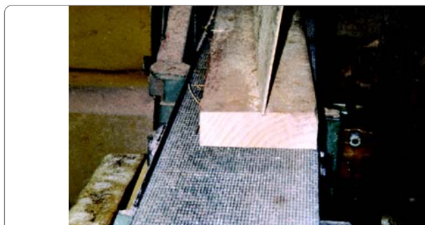
Figura 83. Proceso de reaserrío de madera lateral.
