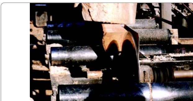
Figura 29. Sierra dimensionadora de 47 cm de diámetro.
