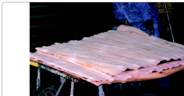
Figura 66. Madera nativa encolada y lista para ser prensada.
