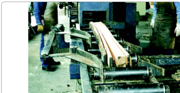
Figura 19. Salida sierra múltiple marca FAB, compuesta por sierras circulares de 4,2 mm de espesor.
