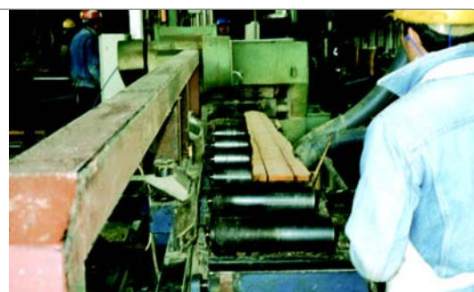
Figura 22. Canteadora marca MIT de tres sierras circulares de 400 mm de diámetro y 4,2 mm de espesor.
