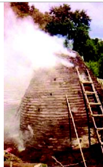
Figura 154. Horno de carbón de ladrillo en proceso de producción.
