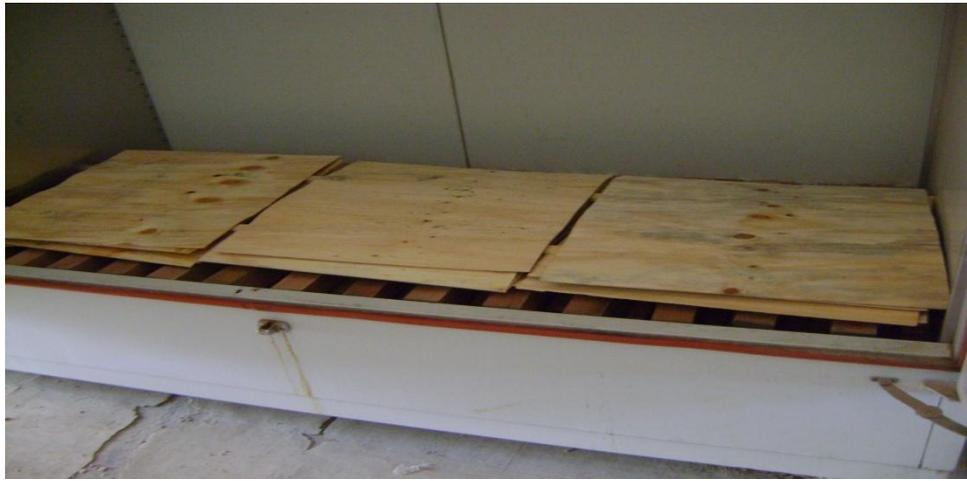
Figura 6. Acondicionamiento de chapas a un 9% CH
